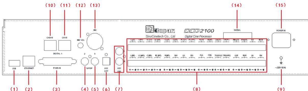
图 4-1 DCP2100 数字电影音频处理器后面板与设备连接图
