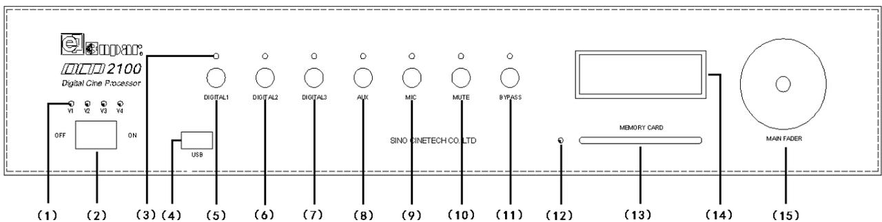
图3-1 DCP-2100声频处理器前面板
